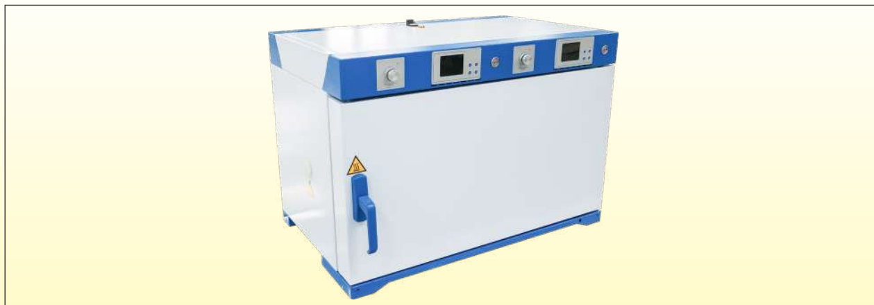
用于在B高达200°C和在M高达150°C的测试装置示例
